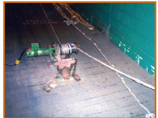
Treuil avec une partie de la corde nouée à proximité sur le plancher
